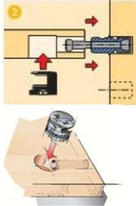
3. При затягивании эксцентрика муфта разжимается.
