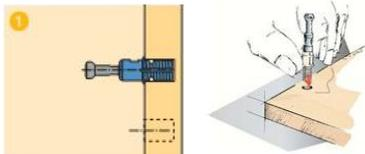
2. Эксцентрик устанавливается в монтажное отверстие.
