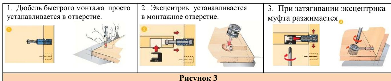
4. Используя эксцентрики 25мм и евровинты 70мм соберите каркас из деталей (поз.1,2,3,4,6).
